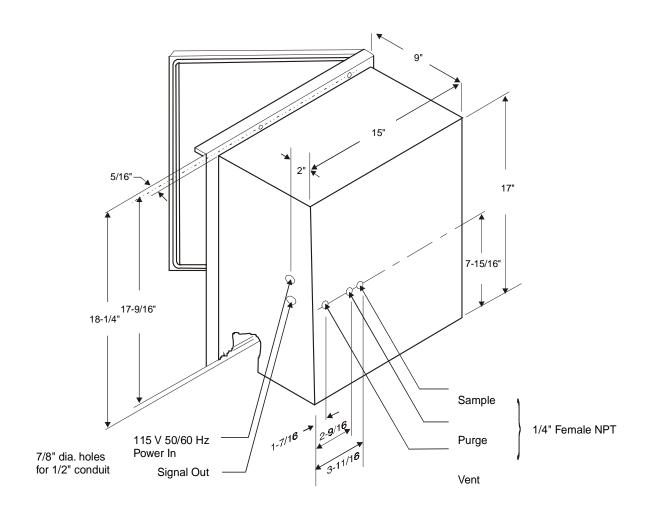
FIGURE 5 ANALYZER OUTLINE DIAGRAM
