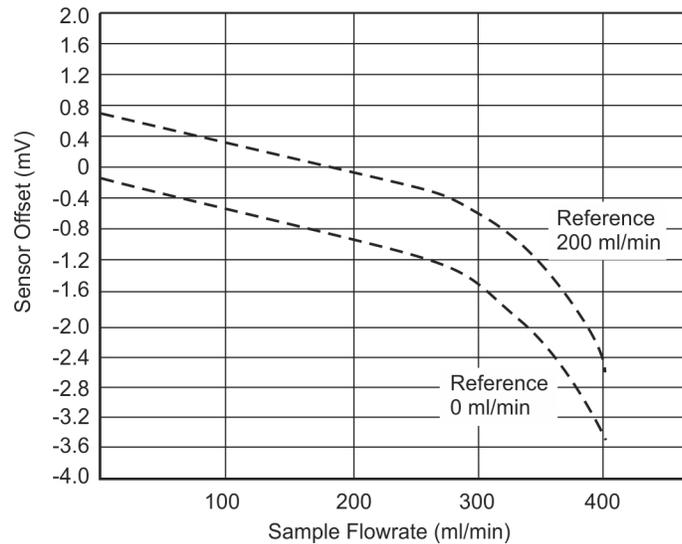
*Figure 2-1: Sensor Offset Voltage*
